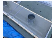
写真-1 流動性および充填性確認試験
