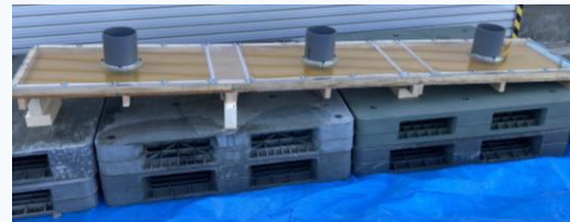
床版下の鋼桁間を模擬した試験体(延長 2.5m 幅 0.4m 隙間 30mm)にサンベストを充填
